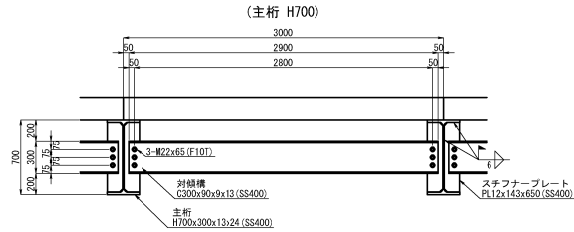
対傾構取付詳細図 S=1:50
